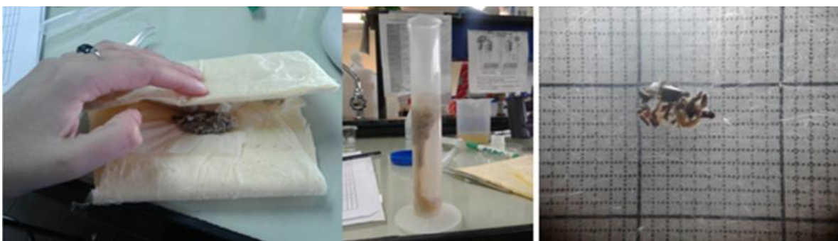
Figura 5. Técnicas de estimación de volumen de presas. A la izquierda método de desplazamiento de volumen; a la derecha utilización de gradilla milimetrada.
