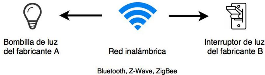
FIGURA 1.2: Modelo de comunicación dispositivo a dispositivo
