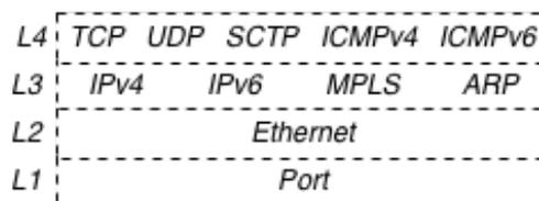
Fig. 2.3 Match fields de OpenFlow 1.3.1. Imagen extraída de [60]
