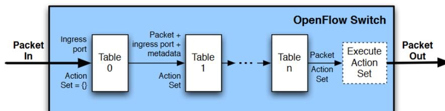
Fig. 2.4 Pipeline de procesamiento de paquetes de OpenFlow. Imagen extraída de [21]
