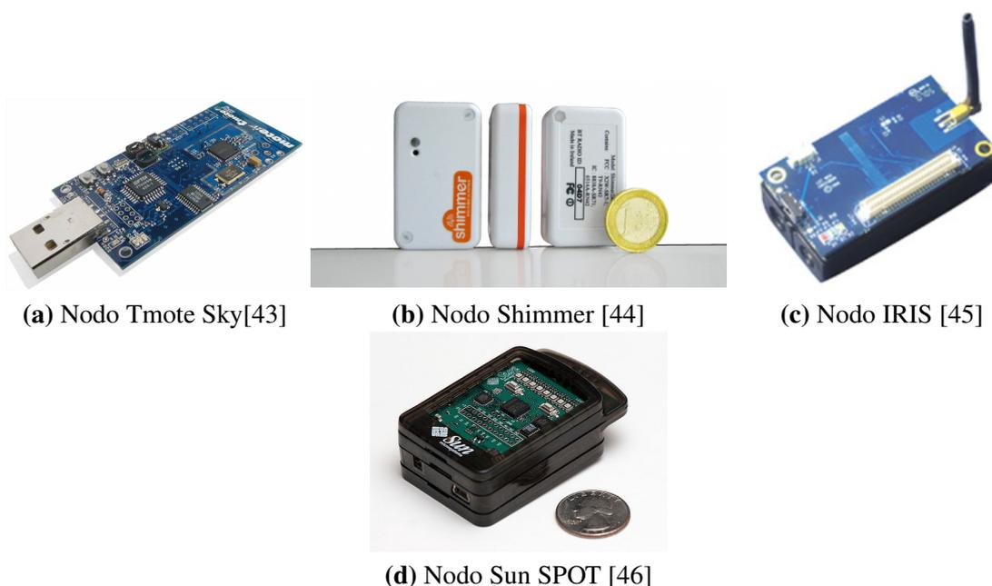
**Figura 2.6:** Plataformas de nodos sensores
