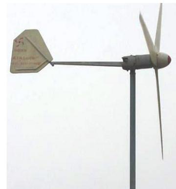
*turbines*) ya que su eje de rotación se ubica en posición paralela al suelo. Tienen dos o tres palas, y generalmente, se fabrican con materiales compuestos (como el caso de la fibra de vidrio). Resultan ser las más comunes en entornos rurales.
