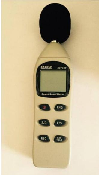
**Figura 3:** Decibelímetro de mano utilizado para realizar las mediciones.
