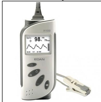
Se utilizan dos longitudes de onda de luz diferentes para obtener el valor de  $SpO_2$ . La absorción de  $HbO_2$  y  $Hb$  difiere en gran medida en la primera longitud de onda, y es aproximadamente igual en la segunda longitud de onda. Típicamente 660 nm (rojo) y 940 nm (longitudes de onda infrarrojas) (Diwei et al., 2015).
