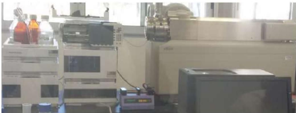
Figura No. 7. Equipo utilizado HPLC-QqQ-MS.
