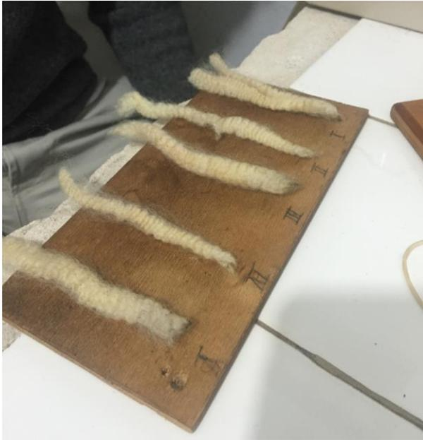
**Figura 8.** Muestras para la determinación de la resistencia de mecha.
