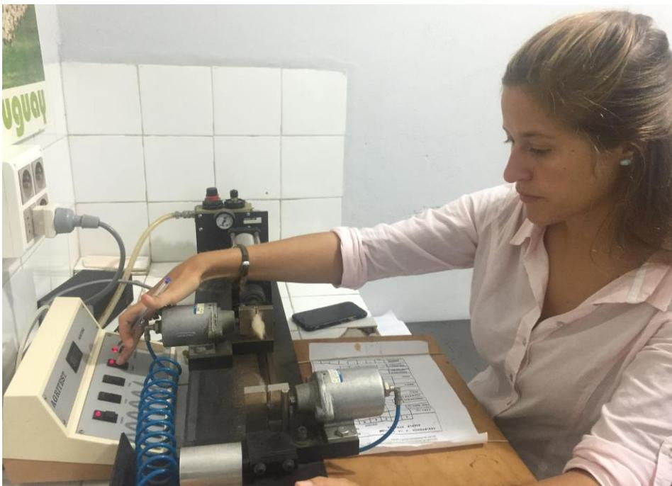
**Figura 9.** Medición de resistencia de mecha mediante el equipo Agritest.
