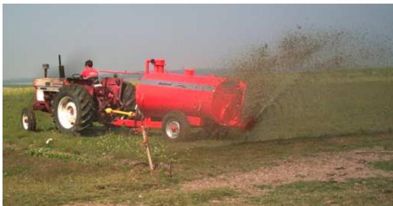
**Ilustración 7- Estercolera empleada para la aplicación del biofertilizante.**
