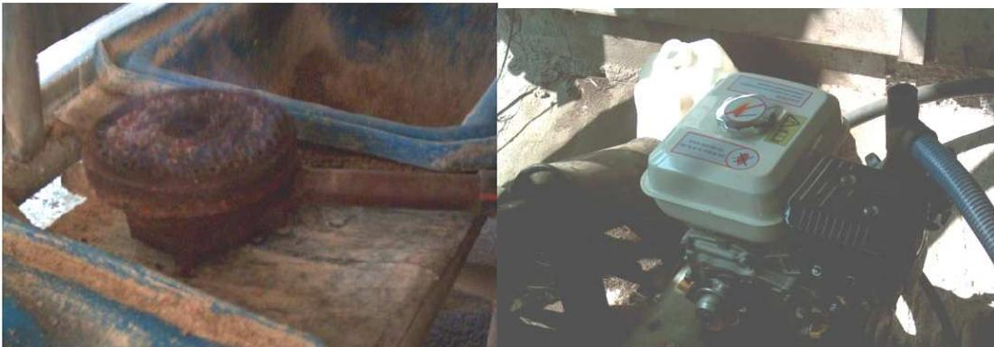
**Ilustración 8- Fotografías del quemador y del motor naftero adaptado para funcionar con biogás.**
