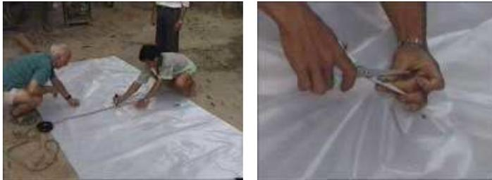
**Ilustración 19 – Corte de la bolsa para la salida del biogás.**
