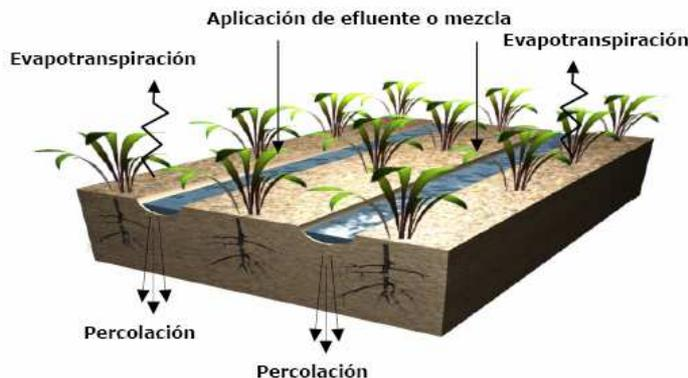
Ilustración 25 – Sistema de riego de tasa lenta aplicado en canaletas.
