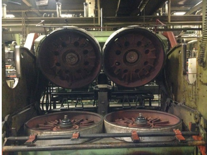
Figura 2.4: Prensa de neumático con compartimientos vacíos (Fuente: Pelmar Engineering Ltd.)
