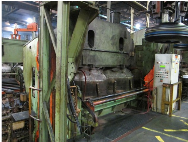
Figura 2.5: Prensa de neumático cerrada (Fuente: Pelmar Engineering Ltd.)
