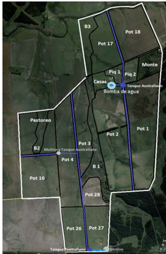
Figura 15. Subdivisiones y red de abastecimiento de agua
