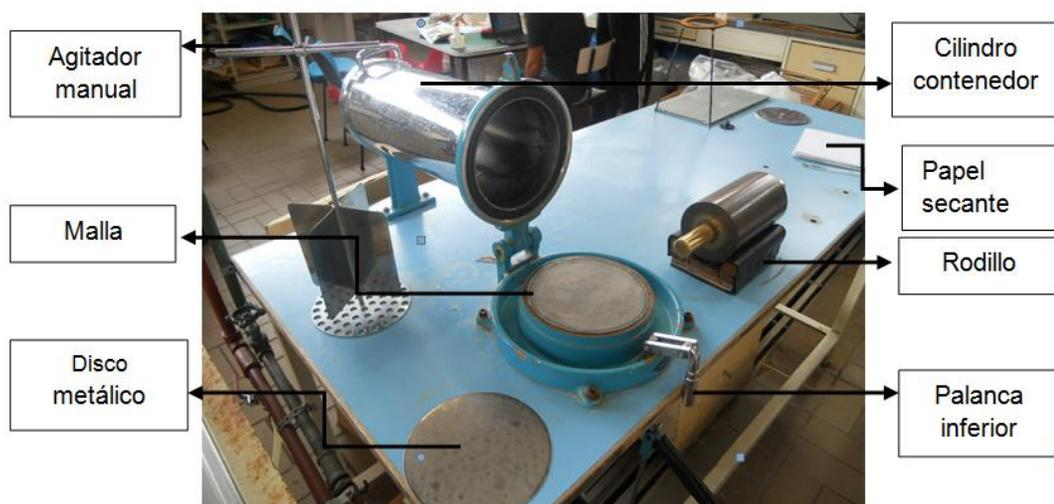
También se utilizan discos metálicos de 160 mm de diámetro y anillos que sostienen las hojas durante el secado y acondicionamiento.
