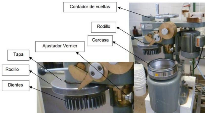
La refinación se realiza según la norma TAPPI T 248 sp 08 que consiste en pesar 30.0 gr de pulpa seca original, hidratarla por un mínimo de 4 horas y un máximo de 24 horas, diluirla en 2 litros de agua y desintegrarla en el pulper.
