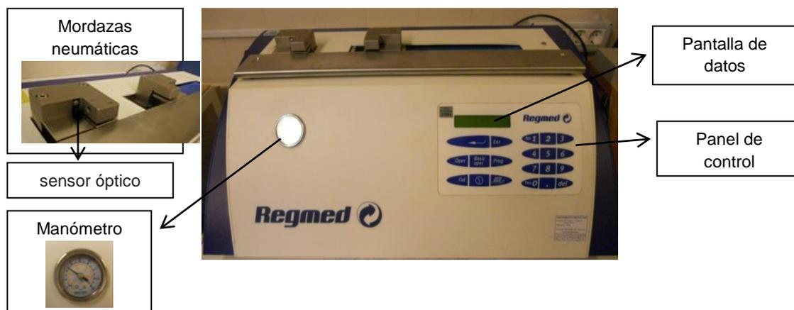
El procedimiento se realiza bajo la Norma TAPPI T 494 om- 06 Una vez seleccionadas las 10 mejores hojas se cortan las 20 probetas, este número asegura un mínimo de 10 resultados válidos.
