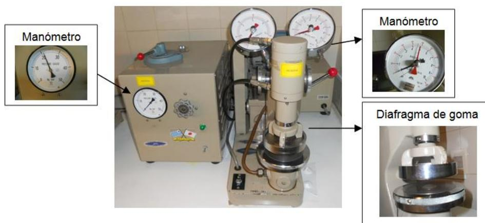
La norma utilizada para la realización de este ensayo TAPPI 403 om-10. Se determina sujetando la probeta sobre el diafragma de goma al que se le aplica una presión hidráulica a una velocidad específica, midiéndose el valor de la presión correspondiente a la ruptura. Cuando la hoja se rompe, la máxima presión alcanzada queda registrada por la aguja secundaria. Se realizan dos medidas por probeta, alcanzando 20 valores por punto expresados en kPa.
