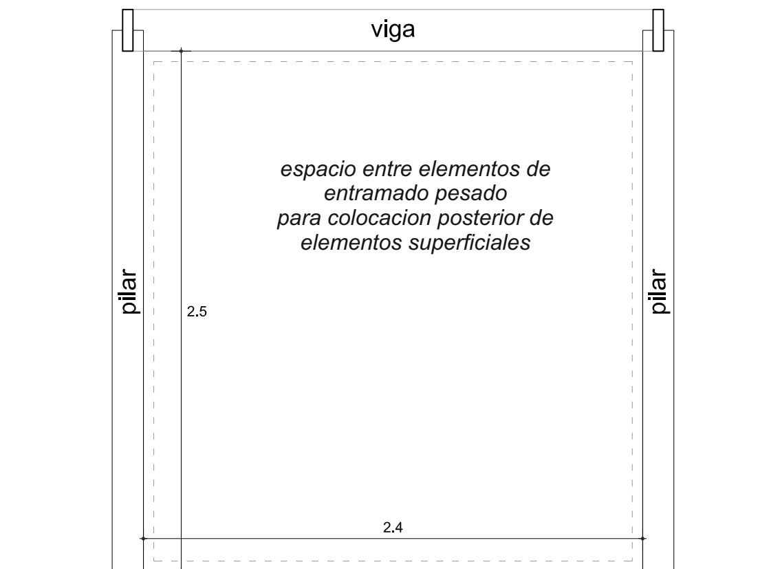
Fig.1 detalle de encastrado de paneles prediseñados con elementos estructurales
