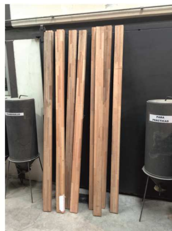
Grafico 25- Se observa las 12 tablas mencionadas anteriormente que unidas entre ellas se creara el panel de madera maciza. [Fuente: foto nuestra]
