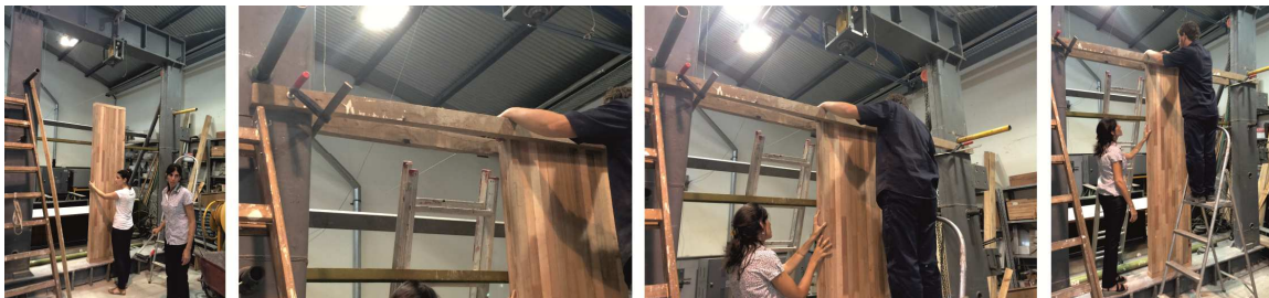
Grafico 32-Colocación del panel en el pórtico de carga-[Fuente: foto nuestra]
