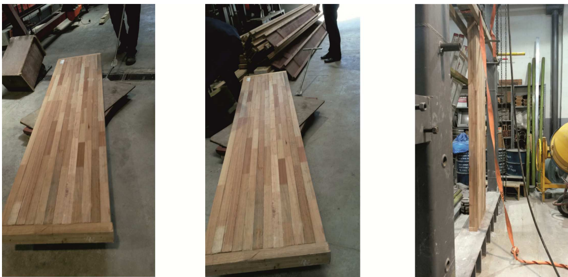
Grafico 32-El Panel después del ensayo-[Fuente: foto nuestra]
