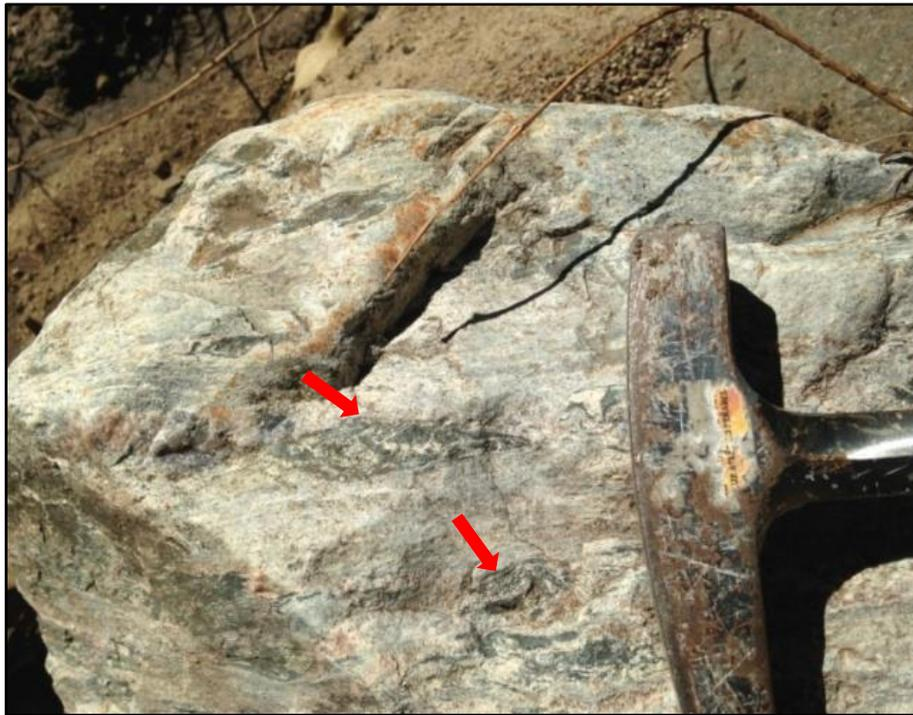
Figura 35. Muestra de metaconglomerados, las flechas rojas señalan clastos deformados que alcanzan los 8 cm.
