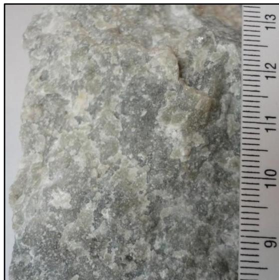
Figura 24c. Muestra de mano de mármoles con tremolita de grano medio a grueso (418389.28 m E/6216434.72 m S).
