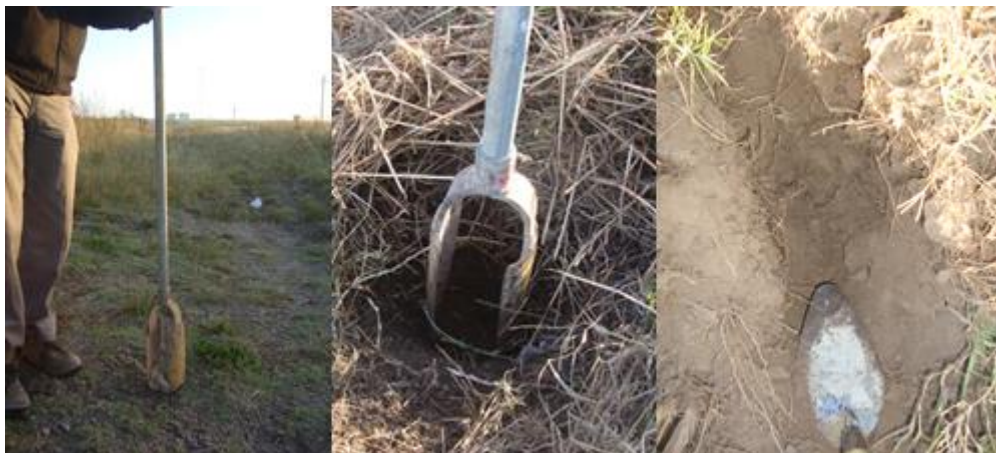
Figura 5: Izquierda: barreno manual tipo Edelman. Medio: realización de pozo para extracción de muestra con barreno. Derecha: toma de muestra de perfil de suelo.
