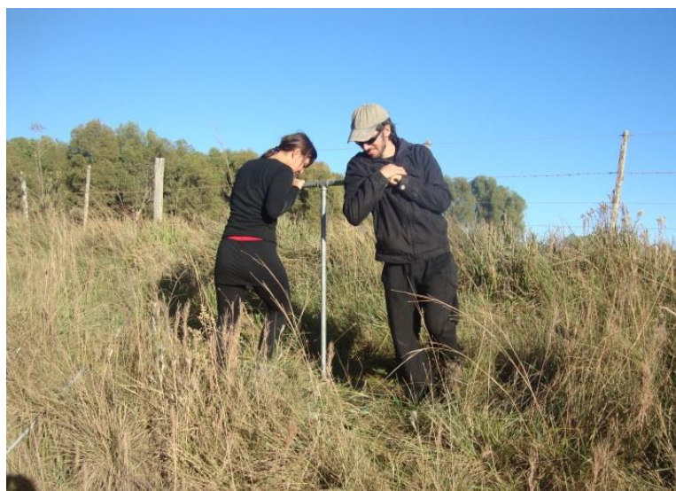
Figura 6: Fotografía tomada durante la perforación de un pozo con barreno manual tipo Edelman.
