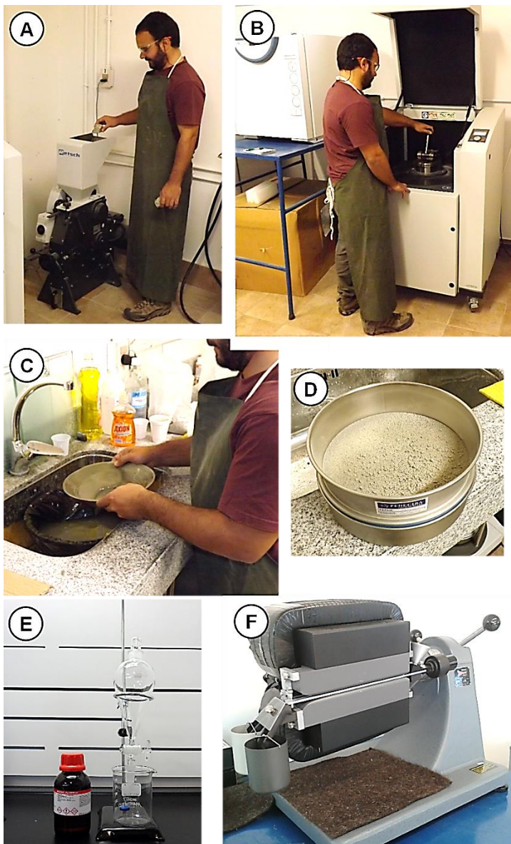
Fig. 4: proceso de separación de circones pertenecientes a una roca. A: trituradora de mandíbulas. B: molino de discos. C: Bateo. D: tamiz 300µm. E: equipamiento de laboratorio utilizado para realizar la separación por líquidos densos. A la izquierda se encuentra el Diiodometano. A la derecha se encuentra el embudo de separación sujeto en su soporte y un vaso se precipitados. F: Separador Isodinámico Frantz.
