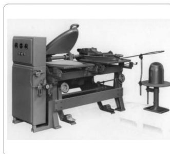
Máquina de hacer sombreros FUENTE: http://www.hatmachines.com/
