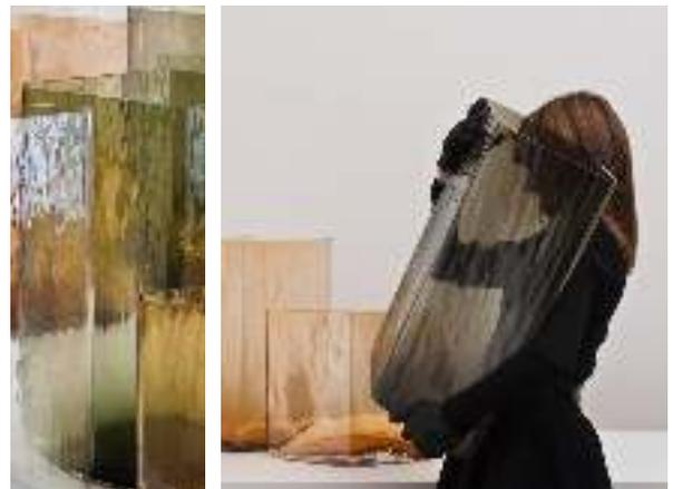
Versión gigante de los Jarrones Ruutu utilizando la técnica de vidrio soplado dentro de un molde de madera
