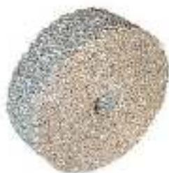
Detalle de Filtro de vidrio sinterizado. , detalle de aparato de vidrio
