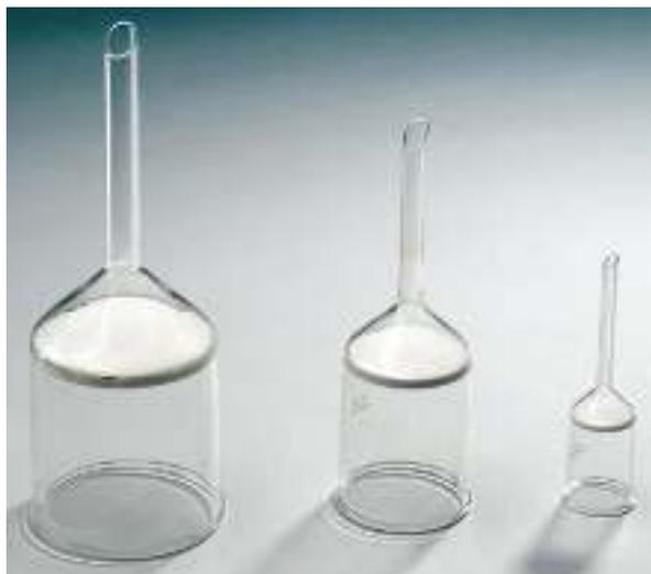
Detalle de aparato de vidrio con filtros de vidrio sinterizado.
