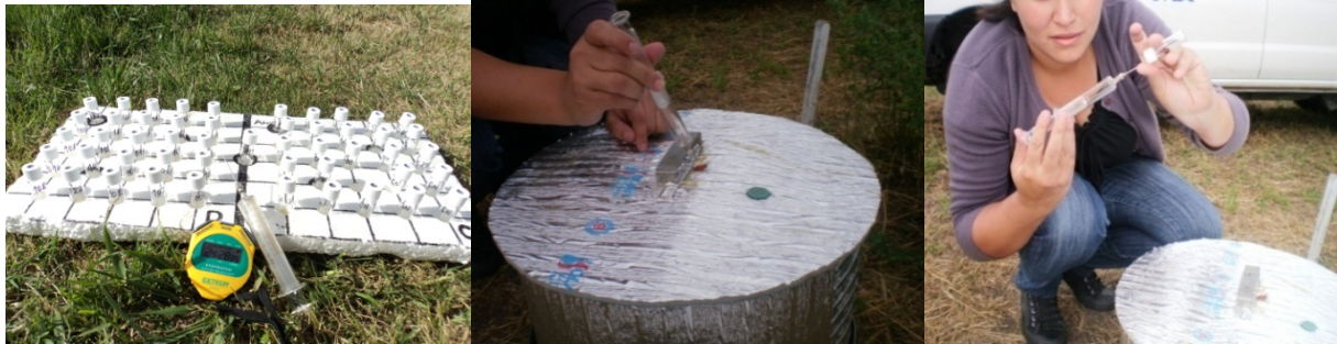
Figura 3. Detalle de la cámara, jeringa, viales y procedimiento de muestreo.
