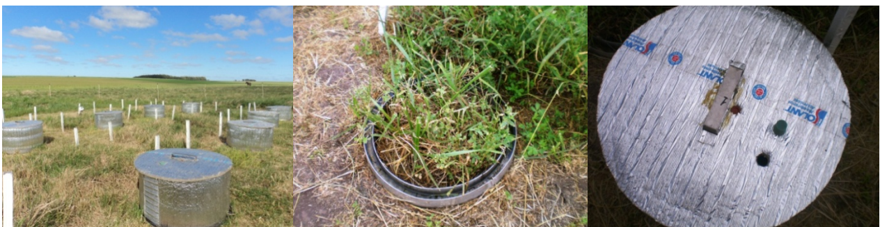
Figura 2. Detalle de las cámaras utilizadas para la medición de N_2O .
