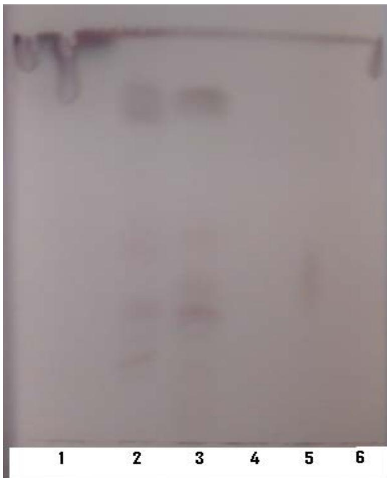
Figura 18. TLC del extracto de eucalipto en acetato de etilo al pasarlo por la columna cromatográfica (1- eucalipto en n-hexano; 2- eucalipto en una mezcla de n-hexano:  $\text{CH}_2\text{Cl}_2$ ; 3- eucalipto en una mezcla de  $\text{CH}_2\text{Cl}_2$ : ácido acético; 4- ácido palmítico; 5- ácido oleico; 6- parafilm); fase móvil: n-hexano: éter etílico y ácido acético 1%..
