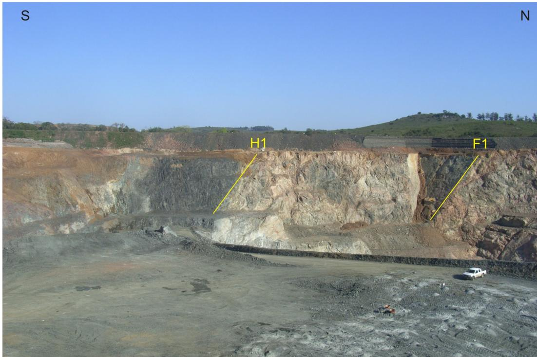
Fig. 11 – Vista de la pared oeste de la mina Arenal, mirando al este, donde se observan las rocas doleríticas al sur de la falla H1 (*Hangingwall fault*), el hidrotermalito mineralizado entre las fallas H1 y F1 (*Footwall fault*) y las rocas félsicas al norte de la falla F1. Altura aproximada del frente expuesto de la mina, 30m.
