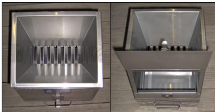
Figura 28. Cuarteador tipo “riffle” (*Jones type riffle splitter*)
