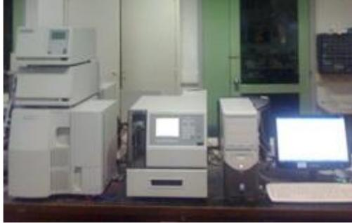
**Figura 7.** Equipo de HPLC-DE utilizado para la cuantificación de los niveles tisulares de DA y DOPAC
