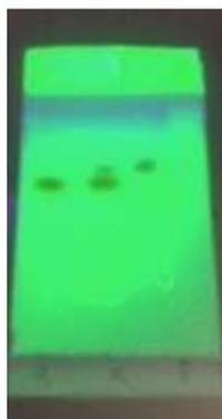
**Figura 3.6:** TLC característico de la obtención de nitroalcano. Carril izquierdo nitroalqueno, carril central co-siembra de nitroalqueno y mezcla de reacción y carril derecho nitroalcano
