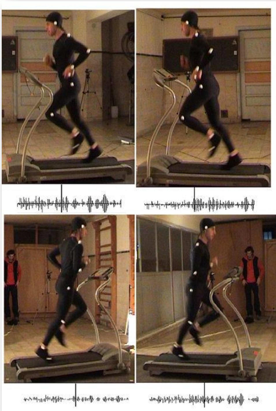
Figura 5. Cuadros de sincronismo de las cámaras 1, 2, 3 y 4. Se observa la señal sonora que permite la identificación de los cuadros de sincronismo.
