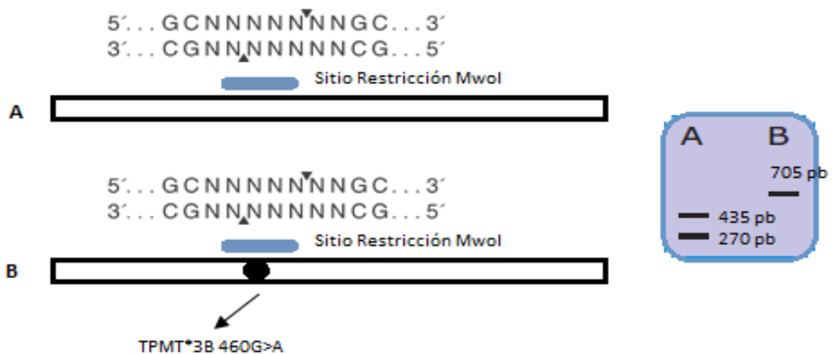
Figura 8: Esquema de corte de la enzima Mwo I para el gen de la TPMT. Si el ADN no a sufrido la sustitución de la base guanina por adenina en la posición 460, la enzima cortara dando lugar a dos fragmentos de 435 y 270 pb. (A). Mientras que si hay mutación, esta eliminara el sitio de corte dando lugar al fragmento original de 705 pb (B).
