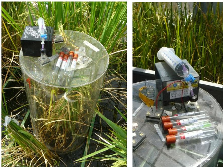
**Figura 1.** Detalle de las cámaras empleadas para cuantificar el flujo de CH<sub>4</sub> y N<sub>2</sub>O emitidos por el suelo en cultivo.
