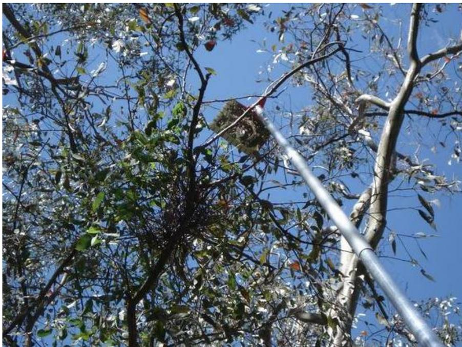
**Figura 8.** Ooscopio formado por secciones cilíndricas de aluminio de 1,5 metros de largo por 3,5 centímetros de diámetro. La sección del extremo superior cuenta con un espejo articulado de 20 por 15 centímetros.
