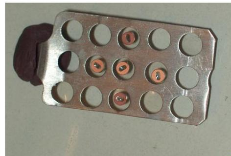
**Figura 10.** Grillas de cobre de orificio único conteniendo los cortes ultrafinos apoyados sobre el film de Formvar.
