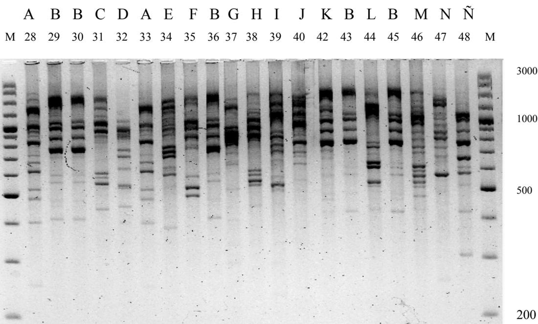
**Fig. 8-** GTG-PCR. Productos de la amplificación con primer (GTG)<sub>5</sub> resueltos en gel de agarosa al 3%. Pocillos 1 y 22 marcador de peso molecular 100 pb Plus (Fermentas). Pocillos 2 al 21: aislamientos de raíz identificados con sus respectivos números. Arriba con letras de la A a la Ñ se indican los diferentes perfiles.
