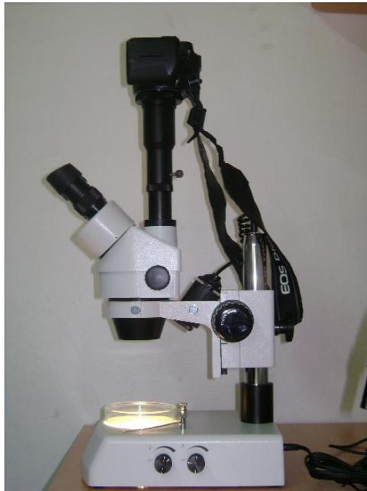
**Fig. 2.** Fotografía de la cámara montada a la lupa, dispositivo mediante el cual se tomaron las fotografías de las mandíbulas.
