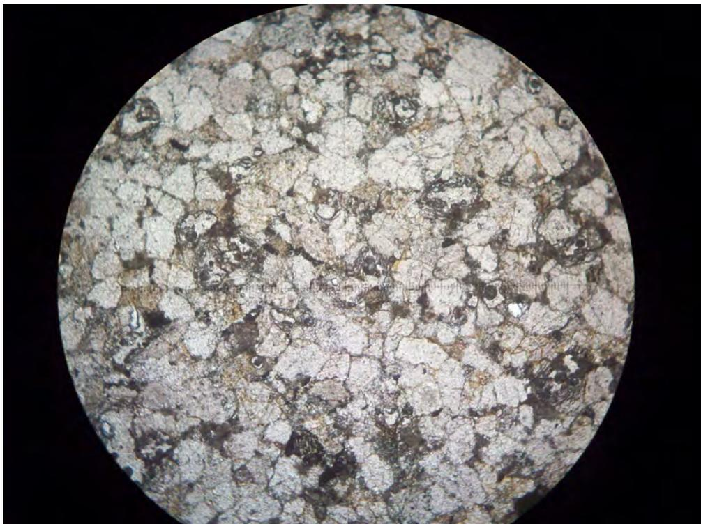
Figura 43 Mismo corte de figura 42 en LN. Diámetro de campo 4 mm.
