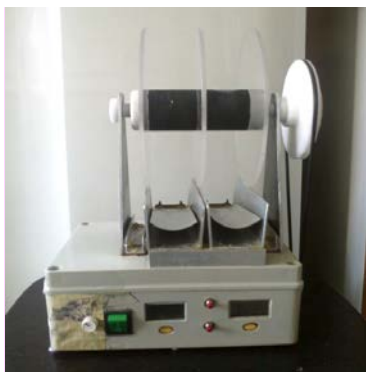
Figura 3.2.1. Barra giratoria a velocidades crecientes (Rotarod). El dispositivo consta de dos carriles donde son situados los ratones sobre la barra. La velocidad se aumenta manualmente. Cuando estos caen se para el cronometro indicando el tiempo de permanencia sobre la barra.
