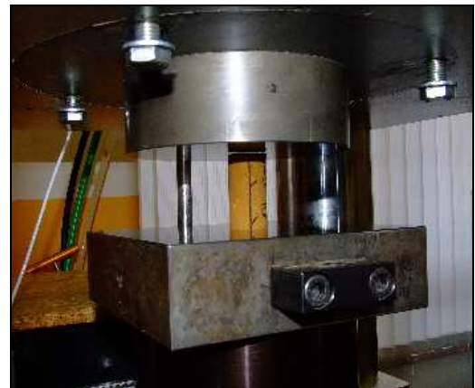
Figura 6.11: Muestra luego del ensayo UCS.
