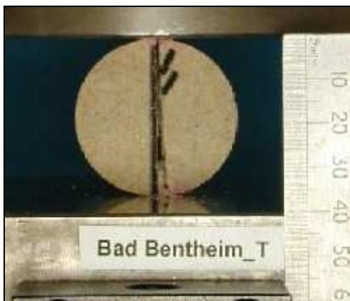
Figura 6.10: Muestra luego del ensayo Brasil.
