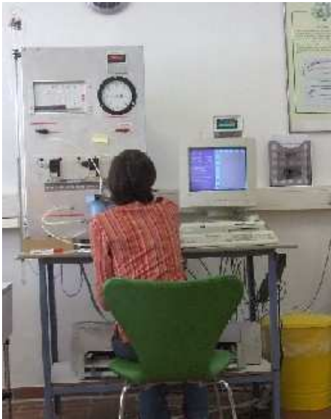
Figura 6.3: Efectuando un ensayo de Permeabilidad.
