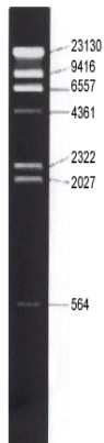
Figura 10: Patrón de bandas en gel de agarosa 1% generado por el marcador de peso molecular \lambda /HindIII.
