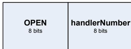
Figura 6.6: Paquete de respuesta del comando `open`
