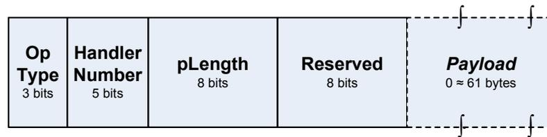
Figura 6.3: Formato de paquete para intercambio de datos utilizado por el *handler protocol*.
