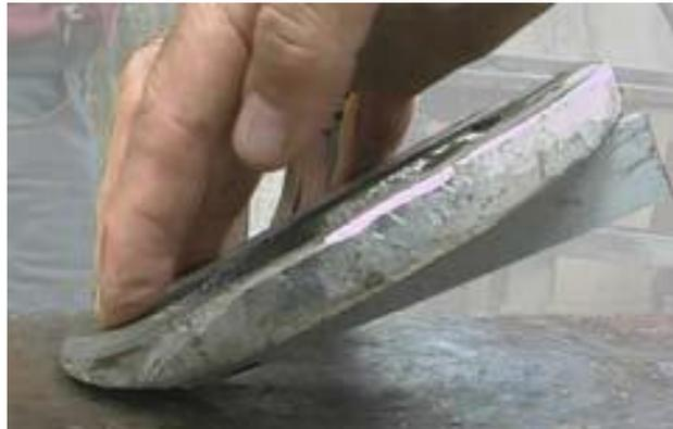
Figura 44. Herradura con barra de corazón y rieles forjada a mano. Las lumbres de la herradura se han gastado con el objetivo de facilitar la ruptura del paso. Se aplicaron rieles de forma triangular a la parte inferior de la herradura, para proporcionar la elevación del talón. Fuente: (Pollitt, 2008).
