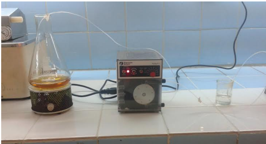
Figura 3: Precipitación con sulfato de amonio. La sal es vertida en un Erlenmeyer que contiene el SLC a un flujo constante de 0,5 ml/min, controlado por una bomba peristáltica y bajo agitación permanente.
