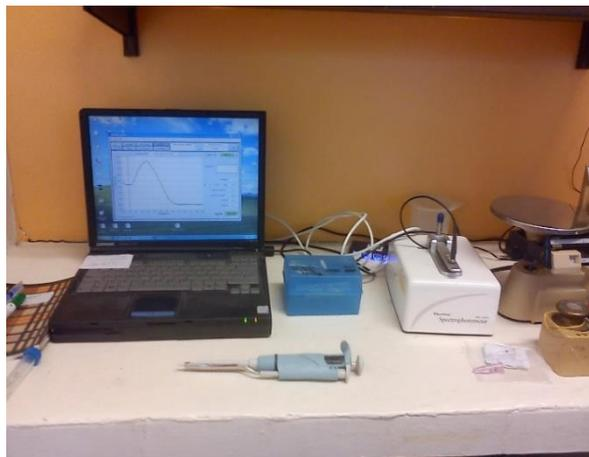
Figura 36. Equipo Nanodrop ND-1000 Spectrophotometer, BCM donde se realizó el análisis de pureza y cuantificación de la muestra de ADN extraído.
