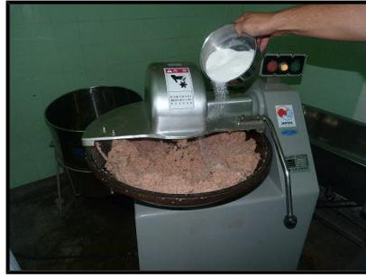
**Figura 20.** Agregado de azúcar en *cutter*.
