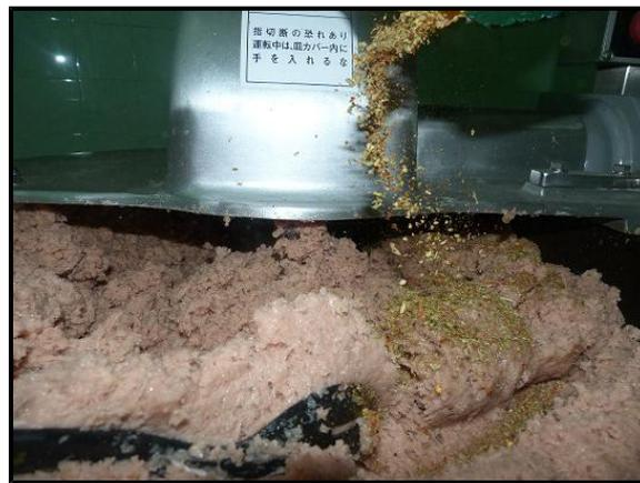
**Figura 27.** Agregado de adobo en cutter.
