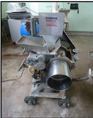
**Figura 16.** Máquina despulpadora.
