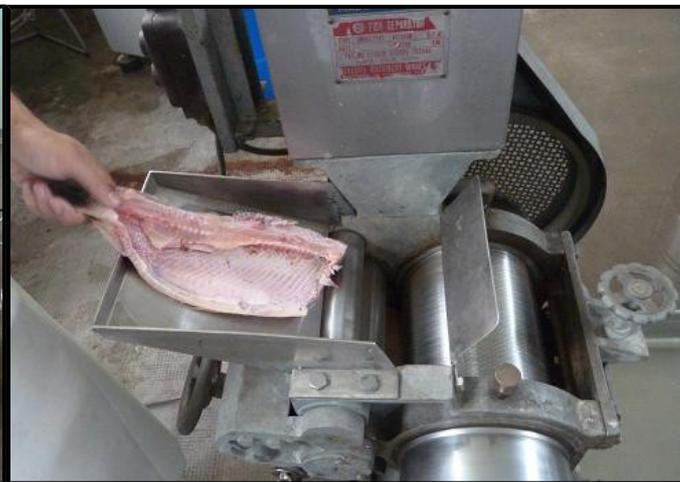
**Figura 17.** Proceso de despulpado.
