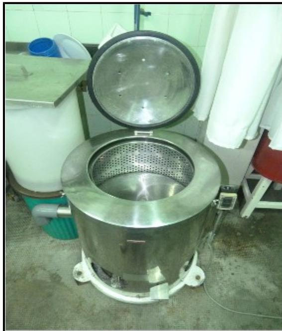
**Figura 24.** Centrifugadora de pulpa.
