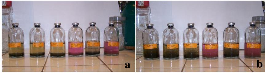
**Fig. 16a.** Observación macroscópica de los viales 7 al 12 en reposo (a) y luego de agitación (b) a los 268 días de incubación. Estos enriquecimientos tenían como sustrato Extracto Celular y las muestras de lodos fueron tomadas de un reactor SBR.
