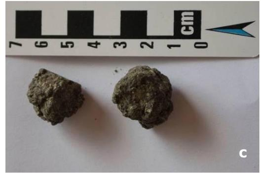
Fig.30. a: Muestra de basalto antes del ensayo. b: luego de tamizado lo que quedó en tamiz ciego. c: Todo lo que quedó retenido en el tamiz  $\frac{3}{4}$ .
