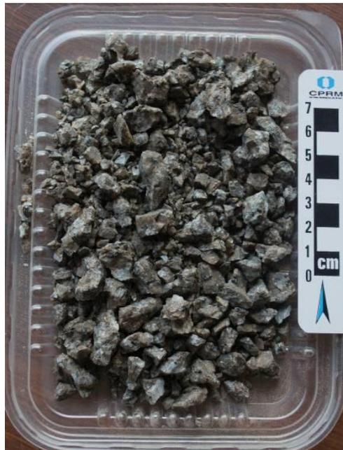
Fig.31. Muestra de granito retenido en el tamiz ciego.
