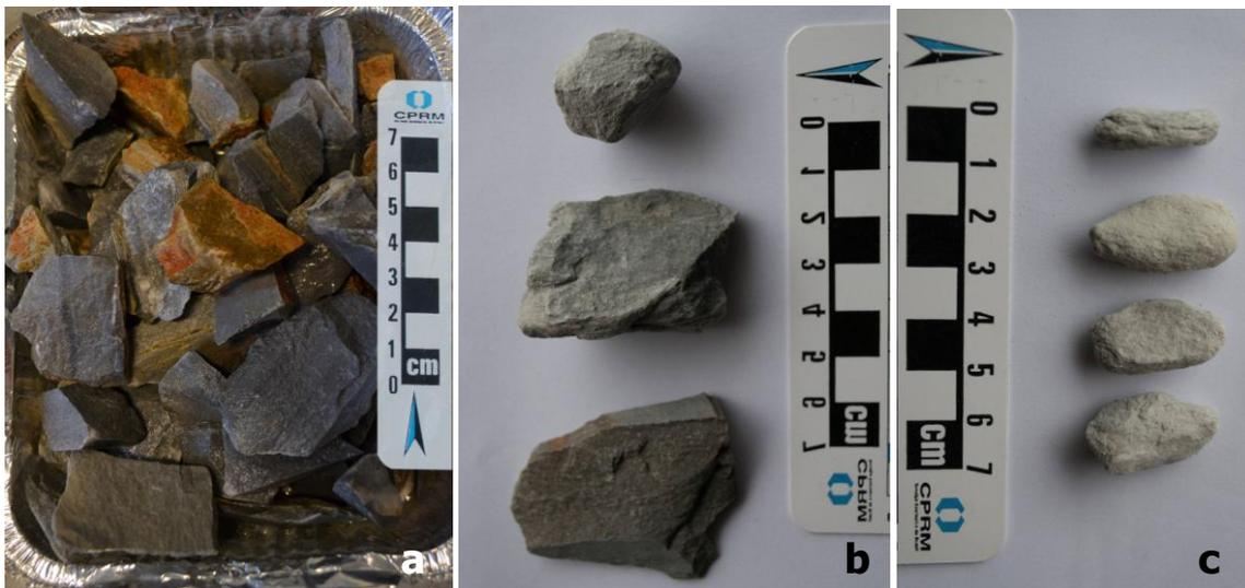
Fig. 29. La imagen ilustra como fueron afectadas las muestras de metacaliza luego del ensayo Na<sub>2</sub>SO<sub>4</sub>. (a: la muestra al comienzo del ensayo. b: foto de los fragmentos representativos retenidos en el tamiz 3/4" al final del ensayo. c: Fragmentos de lo retenido en el tamiz ciego al final del ensayo.)
