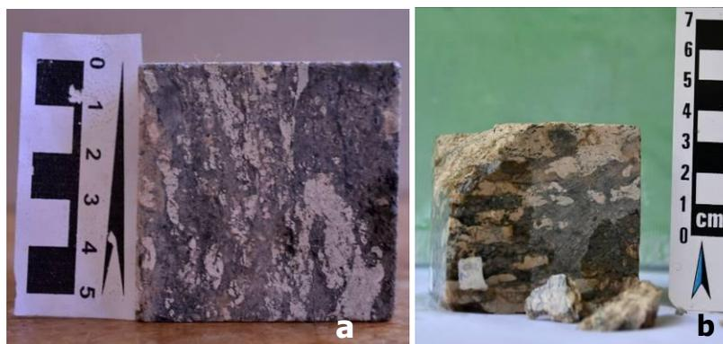
Fig.23. a. Muestra antes de saturar. b. Después de saturar
