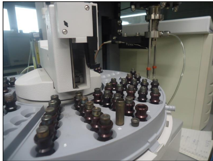
Figura 12: Detalle del filtro donde se coloca la muestra al inicio del análisis (GeoLab Sur).
