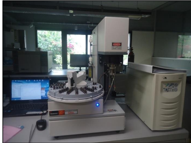
Figura 11: Piroлизador utilizado en los ensayos realizados en este trabajo. Modelo SRA TPH (Total Petroleum Hydrocarbon) (GeoLab Sur).
