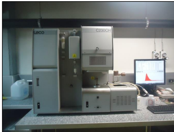
Figura 10: Analizador Leco C230CH utilizado en los ensayos realizados en este trabajo (GeoLab Sur).
