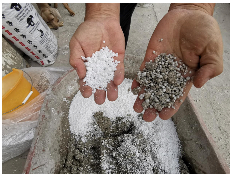
Imagen 12. Muestra de mezcla de EPS con áridos.
